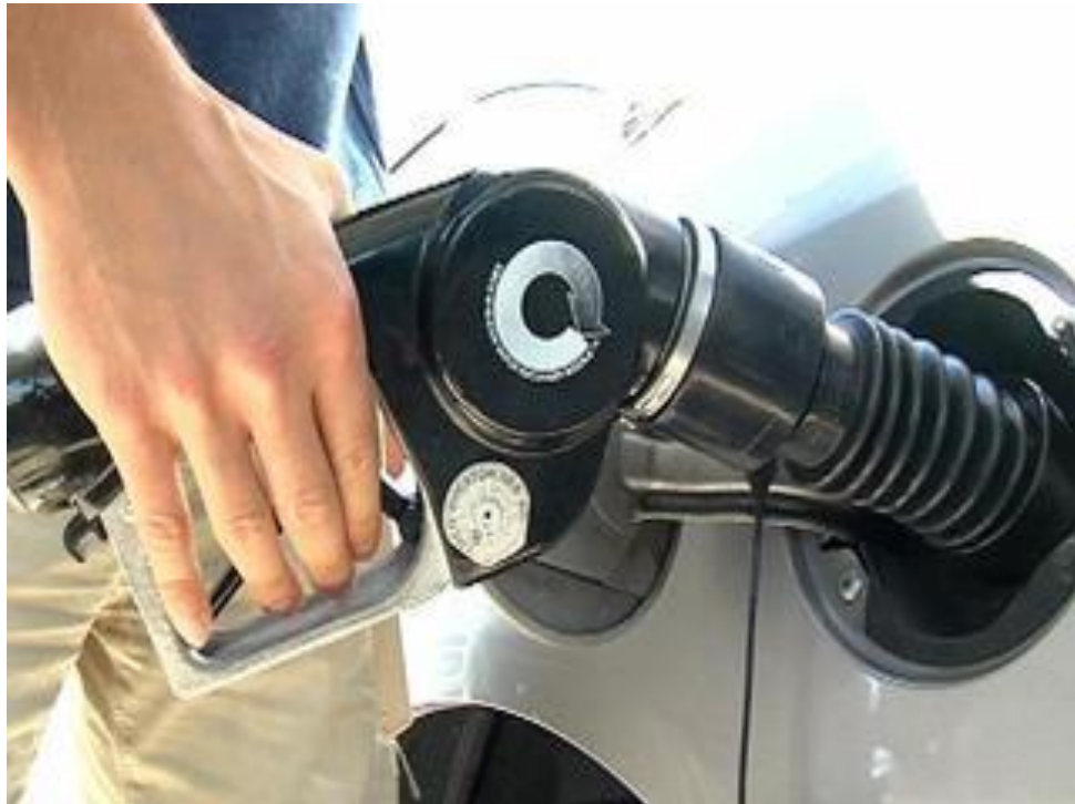
شکل ۲- شماتیک نازل های فعلی که برای برگشت گاز به داخل مخزن استفاده می شوند.
